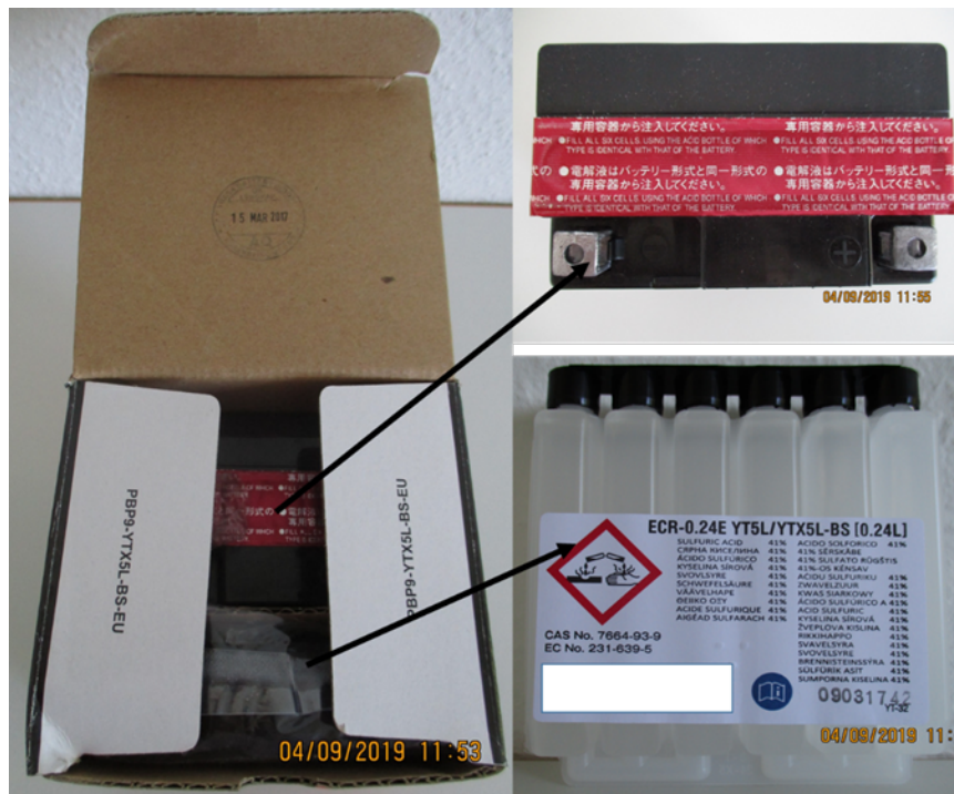
Abbildung 18: Links: äußere Verpackung (Karton Umverpackung) mit Batteriegehäuse und Elektrolyt, Rechts oben: Batteriegehäuse, Rechts unten: Elektrolyt in innerer Verpackung (Polymergebinde) (Quelle: RPT)
