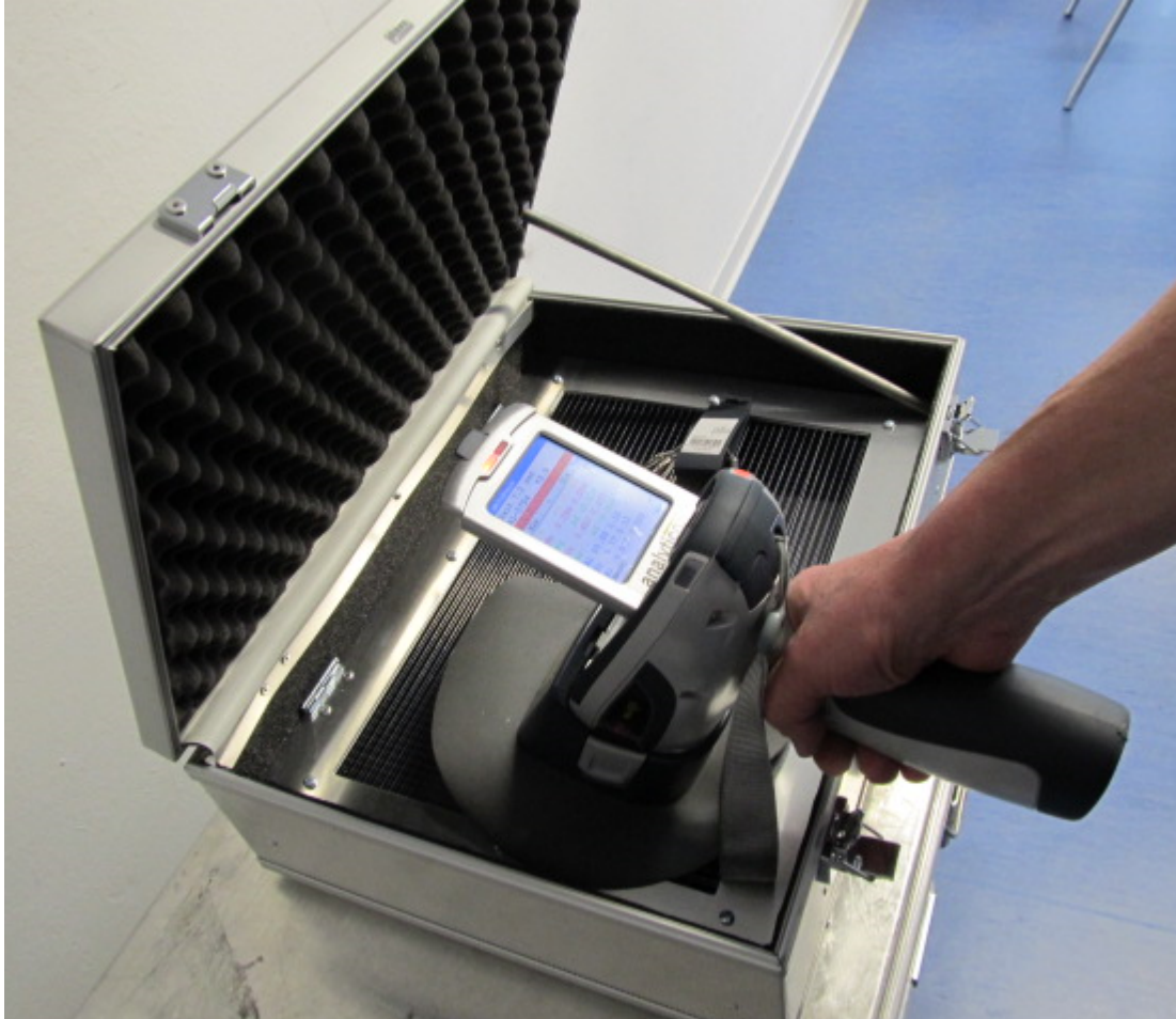
Abbildung 16: RFA-Messung einer Schmuckware (Quelle: RPT)
