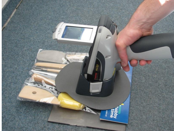
Abbildung 1: Mobiles Röntgen-Fluoreszenz-Analysegerät (RFA) im Einsatz (Quelle: RPT)
