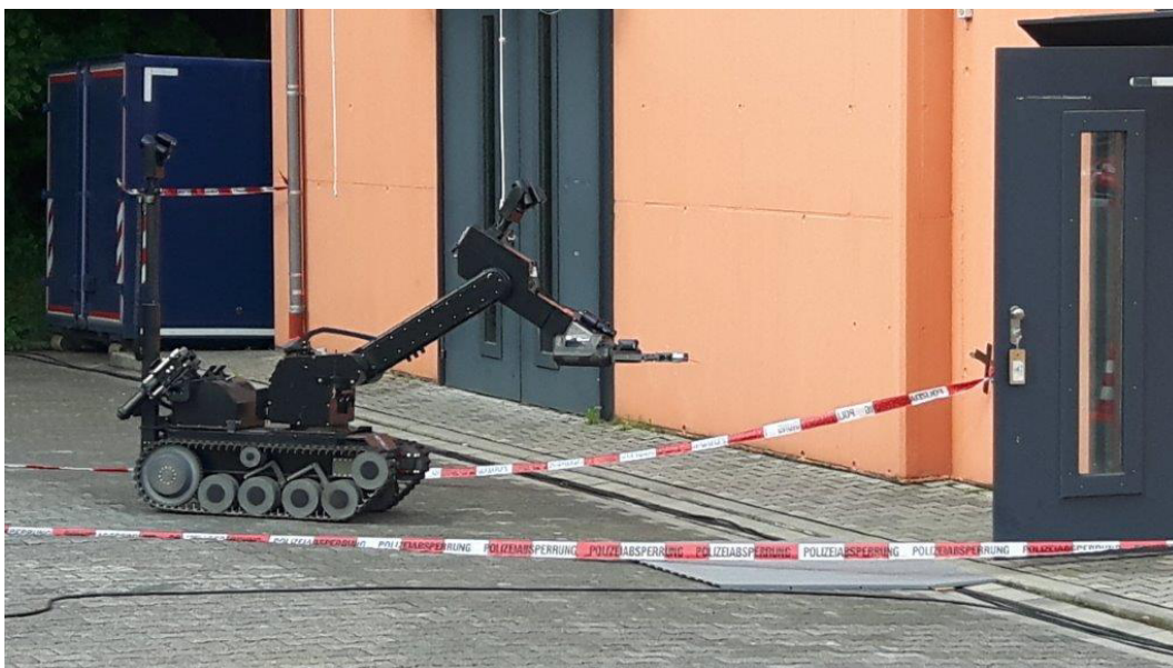
Abbildung 1: Erkundung des Tatorts mittels Fernmanipulator (Quelle: Ministerium für Umwelt, Klima und Energiewirtschaft Baden-Württemberg)
