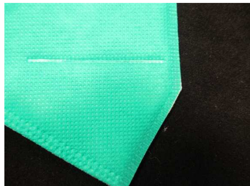
Nahtverschweißung Typ A / Seam welding type A
