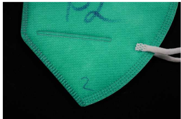
Nahtverschweißung Typ E / Seam welding type E
