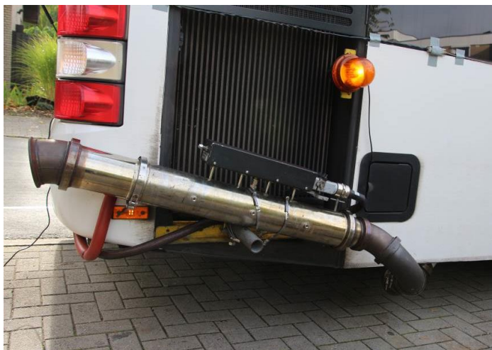
Abgasmessrohr am Testfahrzeug
