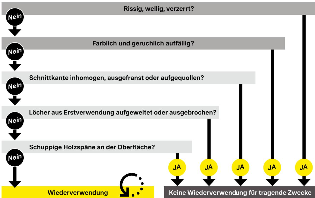
Abbildung B.8: Integritätsprüfung von OSB-Platten
