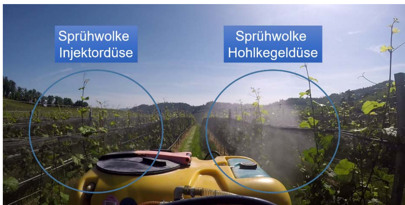
Abbildung 47: Vergleich des Einsatzes von Injektordüsen (links) und Hohlkegeldüsen (rechts). Die Sprühwolke auf der Seite der Hohlkegeldüse lässt auf eine deutlich höhere Abdrift schließen. Foto: Markus Ullrich /LTZ
