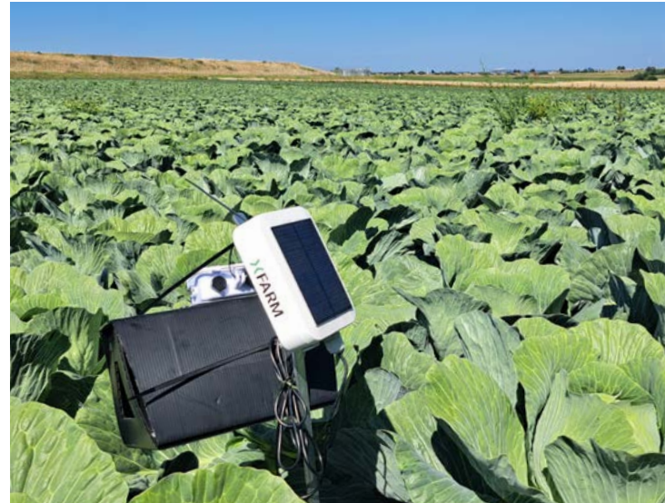
Digitale Pherominfalle zum Monitoring der Kohlmotte Foto: Tom Terbrüggen/LTZ
