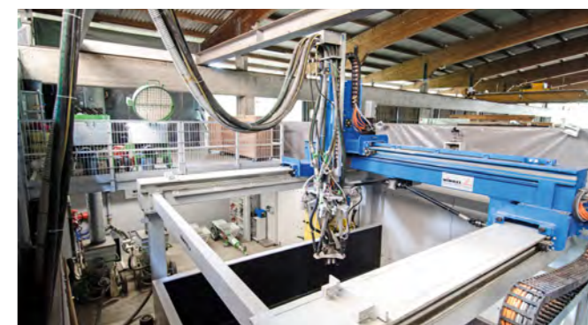
Manipulator zur automatisierten Herstellung funktional gradierter Betonbauteile (Quelle: ILEK, IWB und ISYS, Universität Stuttgart)
